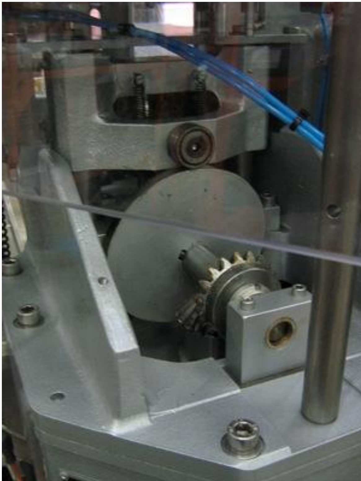
Photo du distributeur de muselets type MECAVAL 25 installé sur MECAVAL 18 & 25
